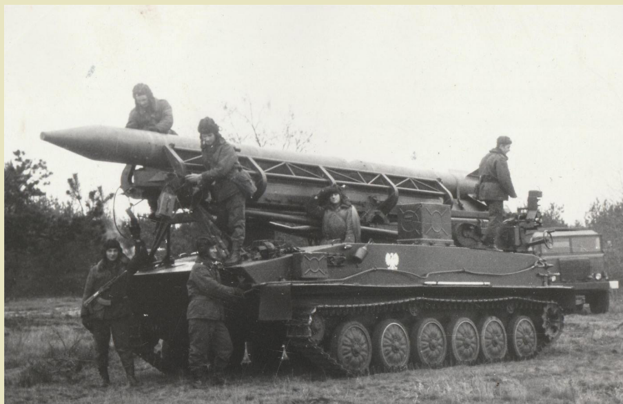
Fot. 5 Wyrzutnia 2P16 na podwoziu czołgu PT 76 z raketą 3R9
