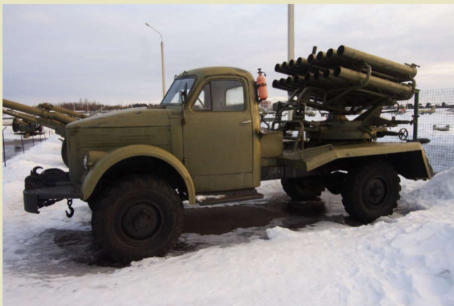
Fot. 2. Wyrzutnia pocisków raketowych BM-14-16 na podwoziu samochodu GAZ-63
