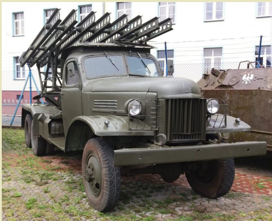
Fot. 1. Wyrzutnia pocisków raketowych BM-13 na podwoziu samochodu ZIS-151
