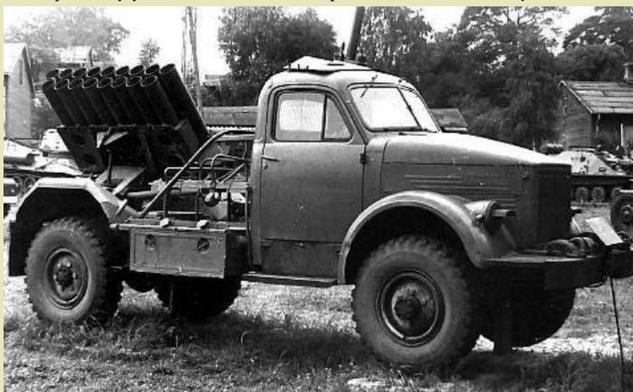
Fot. 3. Wyrzutnia pocisków raketowych BM-14-17 na podwoziu samochodu GAZ-63
