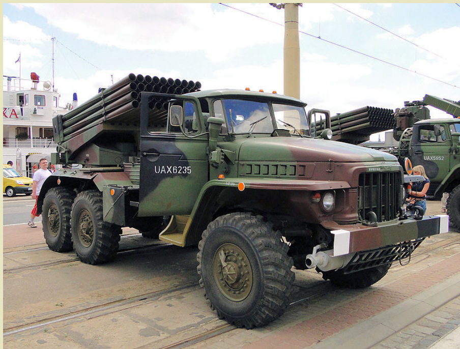
Fot. 4. Wyrzutnia pocisków raketowych BM-21 na podwoziu samochodu URAL-375
